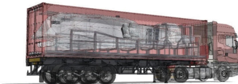
Rys. 5. Wizualizacja platformy typu trimaran w konfiguracji przygotowanej do dyslokacji z użyciem kontenera logistycznego.
